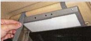
1 Anti-Blend-Licht mittels Klettbindern an der Fahrer-Sonnenblende befestigen; Taster zum Fahrer
