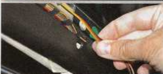
2 Stromkabel in der A-Säule nach unten legen (bei Kopfablag nur durch geschultes Fachpersonal)
