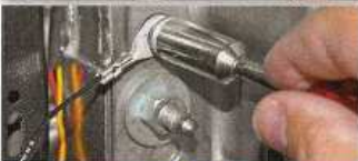
3 Stecker für Zigaretten-Anzünder abwickeln. Minus-Leitung mittels Öse an Masse befestigen
